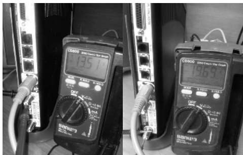
Gambar 12. Pengukuran tegangan keluaran modem
