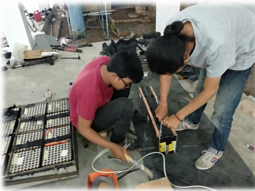
Proses perakitan sistem baterai Neo-BLITZ
