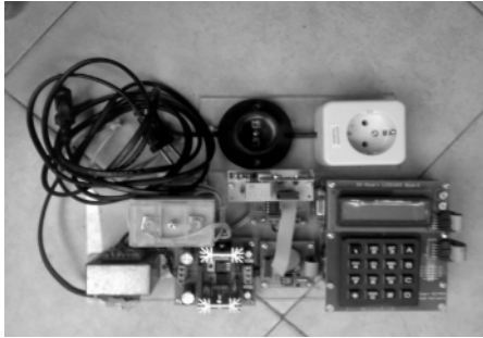
Gambar 7. pencatat data kWh meter jarak jauh terpasang pada pelanggan (Transceiver)
