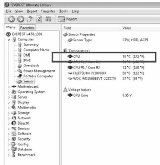
Gambar 6. Tampilan Temperatur CPU dengan menggunakan aplikasi Benchmark.
