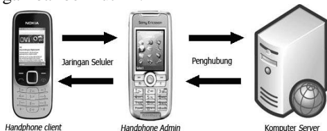
Gambar 1 : Skema Pengiriman dan Penerimaan Request SMS
